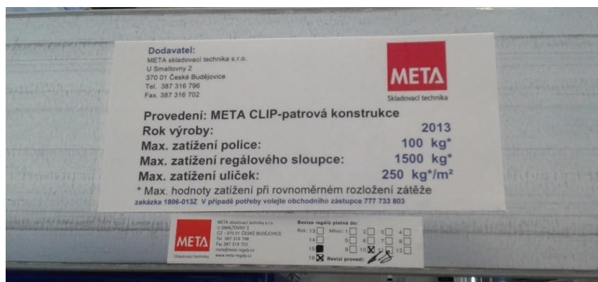
Obr. 3: Revizní (kontrolní) štítek nosnosti regálu.
